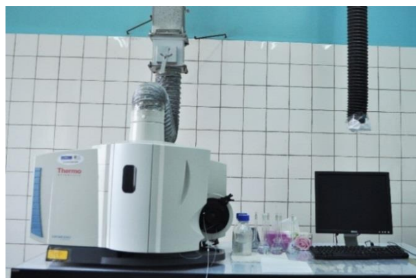
Зураг 3. ICAP-6300 маркийн Индукцийн холбоост плазмын оптик эмиссийн спектрометр, (ICP-OES).
