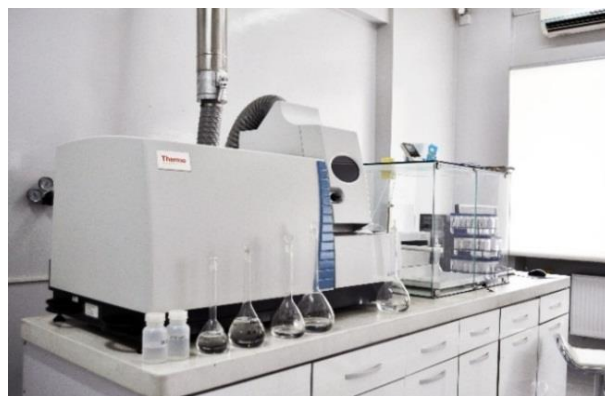
Зураг 2. XSERIES II маркийн Индукцийн холбоост плазмын масс спектрометр (ICP-MS).
