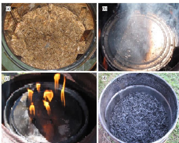
Зураг 2. Модны үртэс (a) шатах механизм: (b) уугих, (c) асах, (d) бионүүрс үүсэх үе шат.
